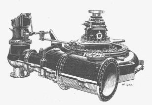
Wasserturbine für das Kraftwerk Wäggital
