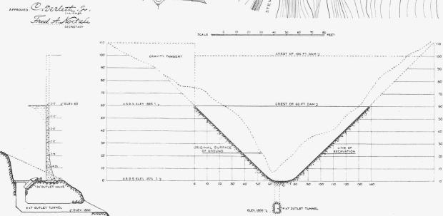
Abb. 1. Grundriss, Aufriss und Schnitt 1:600 der Versuchs-Gewölbe-Staumauer am Stevenson-Creek, Californien.
