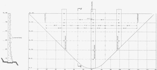
Abb. 6. Durchbiegungs-Messtellen für Klinometer- und direkte Durchbiegungs-Beobachtungen in den drei Türmen an der Luftseite. — Masstab 1:300.
