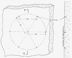
Abb. 5. Gruppe von Spannungsmesser-Bolzen.
