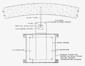
Abb. 8. Schematischer Horizontalschnitt der Beobachtungstürme.
