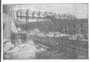
Bockkran, 20 t Tragfähigkeit, 28,5 m Spannweite für einen Stein-lagerplatz (Marmorlager). Società Ligura Marmitera, Carrara.
