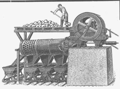
Steinbrecher mit Sortiertrommel.
