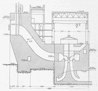
Abb. 6. Querschnitt durch Einlauf und Maschinenhaus. - 1:600.
