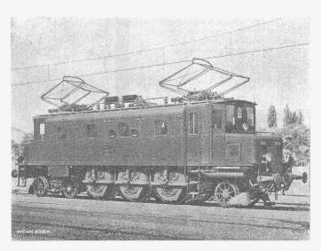
Einphasen - Schnellzuglokomotive mit Einzelachsantrieb, Bauart Brown Boveri, Typ 2C1 für die Schweizerischen Bundesbahnen.
