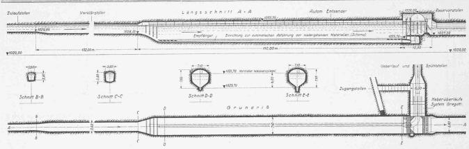
Abb. 1. Längsschnitt, Horizontalschnitt und Querschnitte 1:1000 der Entsandungsanlage nach System Dufour des Kraftwerks Liro-inferiore.
