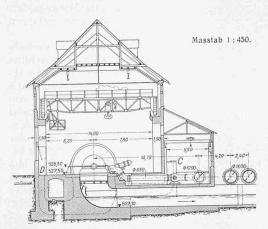
Abb. 81. Querschnitt durch Maschinen- und Schieberhaus.
