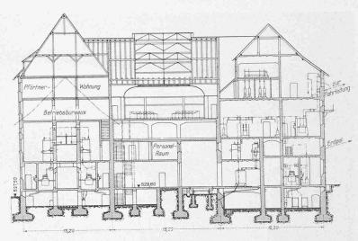
Abb. 81a. Querschnitt durch 15 kV-Schalthaus, Schaltstand-Gebäude und Transformatorenhaus.
