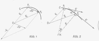
Die erste Ableitung des Kurvenvektors nach dem Parameter liefert einen neuen Vektor, der die Richtung der Tangente hat. (Tangentenvektor). . . . . . . . (I)
