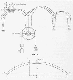
Abb. 5. Messungen an einem Karton-Modell von 20 Zoll Spannweite des dargestellten Bogens. Gemessene Werte; Bei P in Punkt 1: H = 1000 (berechnet 1000); bei P in Punkt 2:920 (930); in 3:720 (720); in 4:420 (400).
