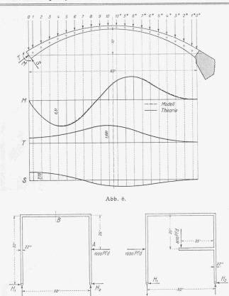
Am Modell gemessener Wert H2: Bei P in A: 238 (berechnet 287), 497,4 (berechneter Wert 497). in B: 81 (75); in A u. B: 364 (362). Abb. 8. Abb. 7. Werte der Horizontalschübe sehr gut übereinstimmen,
