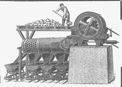
Steinbrecher mit Sortiertrommel.
