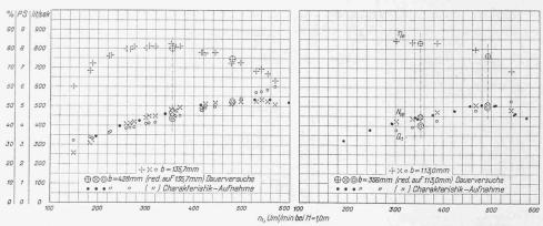
Abb. 34. Messungsergebnisse an einer Bell-Extra-Schnelläuferturbine mit  $D_s = 16(0 \text{ mm im Vergle}^t\text{ch}$  zu den Ergebnissen der Modell-Turbine mit  $D_s = 505 \text{ mm}$  und gleicher Saugrohrform.
