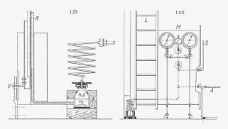
Abb. 32. Kombinierte Manometer der Hochdruck-Anlage. LEGENDE: A Anschluss an natürliches Hochgefälle H = 75 m oder an Handpresspumpe, L Bedienungsleiter, M Manometer, R Steigschenkel des U-Rohrs, 3 mm lichter Durchmesser, S Standrohr zur Fixierung der Null-Lage der Quecksilbersäule, V Skalenverstellung.
