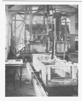
Abb. 31. Bewegliche Versuchseinrichtung für Prüfung kleiner Laufräder von 150 bis 200 mm Durchmesser.
