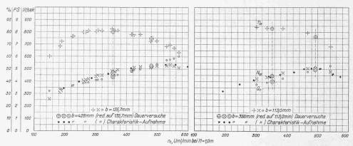
Abb. 34. Messungsergebnisse an einer Bell-Extra-Schnelläuferturbine mit  $D_s=16(0\ mm$  im Vergleich zu den Ergebnissen der Modell-Turbine mit  $D_s=505\ mm$  und gleicher Saugrohrform.
