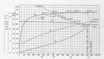
Abb. 35. Messungsergebnisse an einer Peltonturbine von 1500 PS Leistung (ausgezogene Kurven) im Vergleich zu den Ergebnissen an der Modellturbine von 50 PS (Punkte mit eingetragenen Werten).
