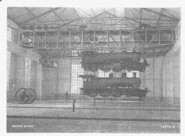
Belastungsprobe eines Lokomotivhebekranes der Reparaturwerkstätte Yverd in der Schweizerischen Bundesbahnen.
