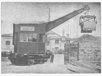
Lokomotivdrehkran mit Akkumulatorenbetrieb, 5 Tonnen Tragkraft.
