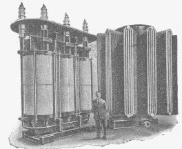
Drehstrom-Oeltransformator von 13000 kVA, mit Oelkühlung 70 000/13500 Volt
