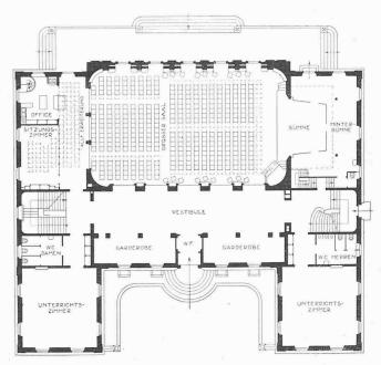
Abb. 3. Grundriss vom Hauptgeschoss. — 1:400.
