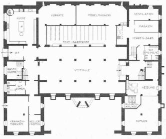
Abb. 2. Grundriss vom Untergeschoss. -1:400.
