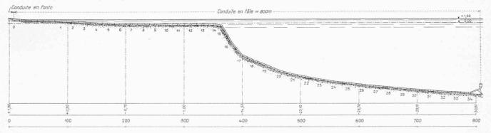
Fig. 1. Profil en long de la conduite. - Echelle des longueurs environ 1:4000; échelle des hauteurs environ 1:1000.
