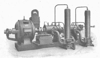
Leicht transportable Kompressoranlage für 5-10 Atm Druck.
