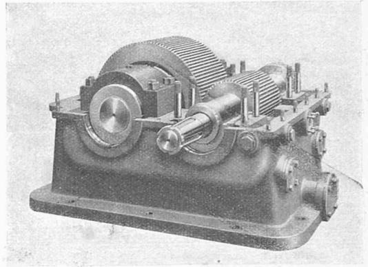
Abb. 3. Uebersetzungsgetriebe zur Dampfturbine Seite 321.
