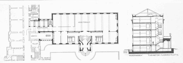
Abb. 2. Grundriss des Erweiterungsbaues (links Anschluss an den bestehenden Bau). - Masstab 1:500. - Abb. 3. Schnitt,
