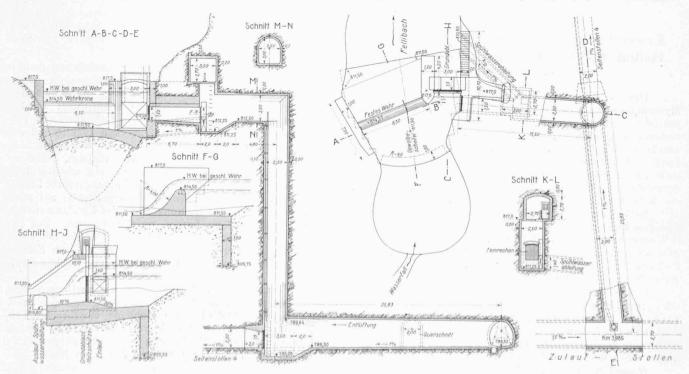
Abb. 42. Fassung und Einleitung des Fellibaches in den Reuss-Zulaufstollen (vergl. Längenprofil Seite 285), - Grundriss und Schnitte 1:400,
