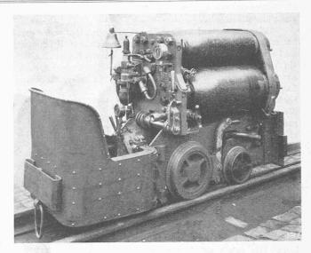
Zwerg-Druckluftlokomotive füri 175 at der "Demag" Duisburg.
