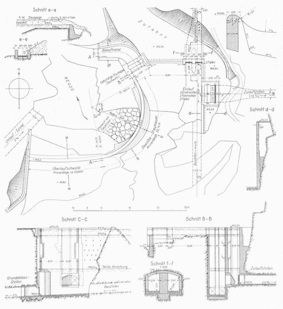
Abb. 14. Die Gewölbe-Staumauer am Pfaffensprung zwischen Wassen und Gurtnellen. Grundriss und Schnitte von Mauer, Grundablass und Stolleneinlauf 1:600 bezw. 1:300 (Detail der Mauerkrone, oben rechts, 1:150).
