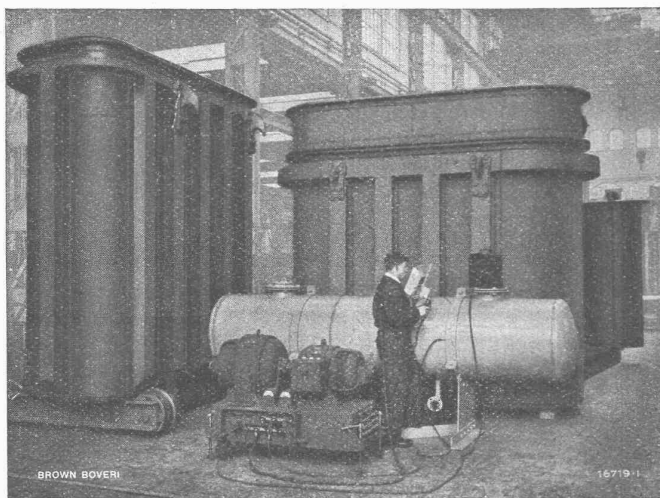
Mit Brown Boveri Lichtbogen-Schweißgruppen elektrisch geschweißte Groß-Transformatorenkessel.
