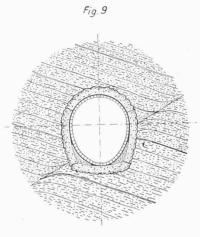
Rekonstruktion eines durchlässigen Druckstollens mit Hülfe einer innern Holzverkleidung auf Lehmunterlage,
