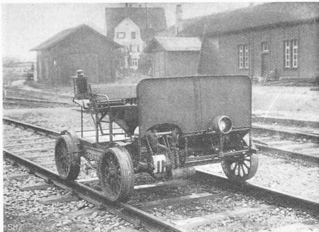
Abb. 3. Motor-Draisine des Leitungsaufsehers.
