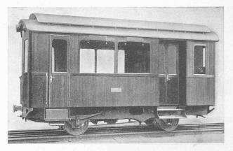
Abb. 1. Schmalspuriger Benzin-Triebwagen für max. 62 km/h Fahrgeschwindigkeit.
