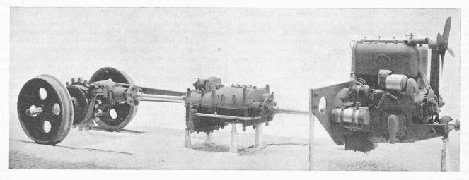
Abb. 4. Antrieb des meterspurigen Benzinmotor-Triebwagens für gemischten Adhäsions- und Zahnradbetrieb. (Text siehe Seite 186/197.) Saurer-Benzinmotor von 68 PS, Geschwindigkeits-Wechselgetriebe mit Oeldruckschaltung der Schweizer. Lokomotivfabrik Winterthur.
