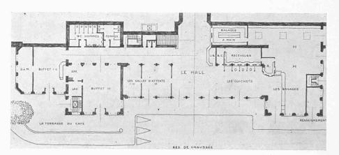
Entwurf Nr. 2. Grundriss des Erdgeschosses. - Masstab 1:600.
