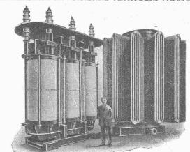
Drehstrom-Oeltransformator von 13000 kVA, mit Wasserkühlung 70000/13500 Volt
