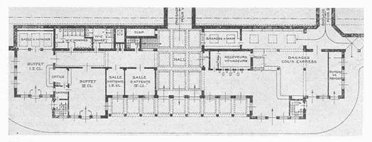
Grundriss des Erdgeschosses. - Masstab 1:600.
