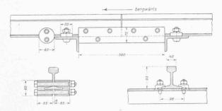
Abb. 4. Oberbau der Seilbahn Harissenbucht-Fürigen. — Masstab 1:10.
