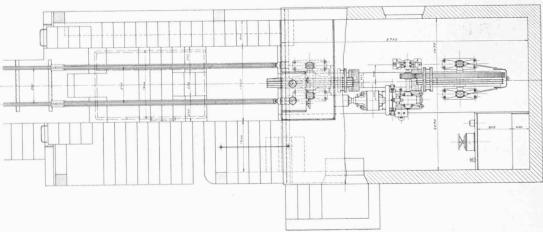
Abb. 6. Grundriss und Längsschnitt der obern Station. Mechanischer Teil von Th. Bell & Cie., Kriens. — Masstab 1:80.
