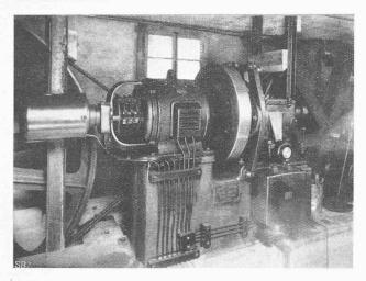
Abb. 7. Triebwerk in der obern Station.
