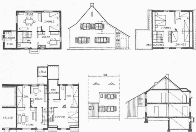
Oben: Ansicht und Grundrisse eines 5-Zimmer-Einzelhauses 1:400. Unten: Ansicht, Schnitt und Grundrisse eines 4-Zimmer-Reihenhauses 1:400.
