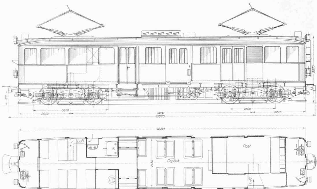
Abb. 1. Seitenansicht und Grundriss eines neuen elektrischen Motorwagens der M. O. B. — Masstab 1:100.
