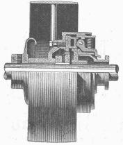
Benn-Kupplung, Typ NN, in Verbindung mit Riemenscheibe
