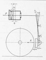
Abb. 14. Schema eines Bremsgestänges mit veränderlichem Uebersetzungsverhältnis.
