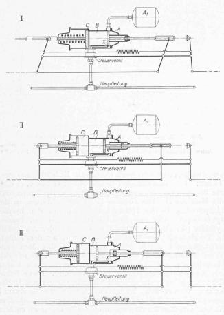
Abb. 10. Schema der Kunze-Knorr-Güterzugbremse.
