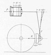
Abb. 13. Schema eines Bremsgestänges mit festem Uebersetzungsverhältnis.
