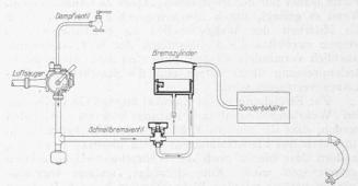
Abb. 9. Schema der Vakuum-Güterzug-Schnellbremse,
