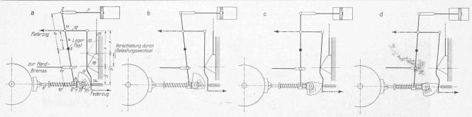
Abb. 15. Schema des Bremsgestänges Bauart Scheuer mit automatischer Veränderung des Uebersetzungsverhältnisses.
