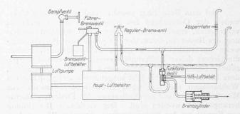
Abb. 8. Schema der Westinghouse-Güterzugbremse.
