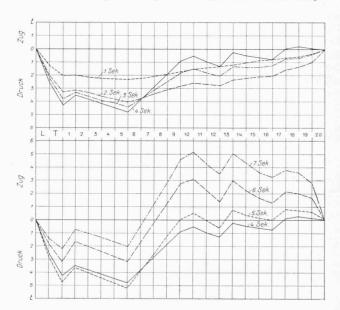
Abb 6. Aenderung der durch die Stoss- und Zugvorrichtungen aufzunehmenden Kräfte, von Sekunde zu Sekunde, in einem Zug von 20 Wagen.
