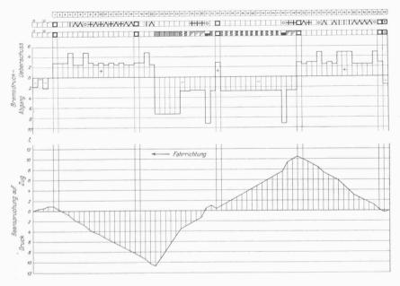
Abb. 3 bis 5. Beanspruchung der Zug- und Stossvorrichtungen eines Zugs von 66 Wagen während der Bremsung, bei verschiedenen Stellungen der vollbeladenen Wagen in der Zugskomposition.
