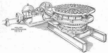
Drehrosfenfleerung für Zemenf-Schachföfen
