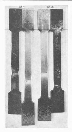
Abb. 9. Zugversuche mit grossen Flachstäben.
