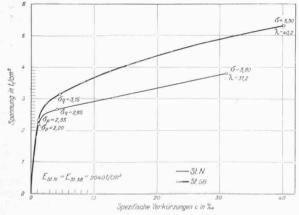
Abb. 11. Spannungs-Dehnungs-Diagramm der Druckversuche mit Prismen 1 × 1 × 3 cm,
