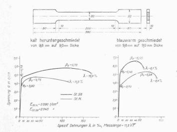
Abb. 6. Spannungs-Dehnungs-Diagramme der Zugversuche mit grossen Flachstäben aus Material St. N und St. 58. Verschmiedungsmass 1:12
