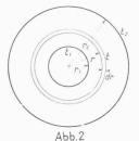
mentar-Hohlzylinder von der Achsenlänge 1, vom Radius r und der Dicke dr ist der Sitz der Wärmeproduktion J. dV, zufolge des Ohmschen Widerstandes:
