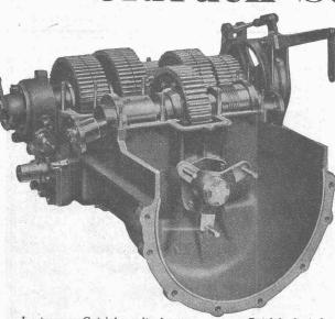
Lastwagen-Getriebe mit abgenommenem Getriebedeckel
