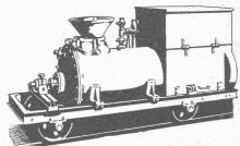
Mit dieser Cementinjectionsmaschine, Patent,
