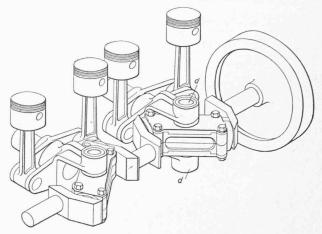
Abb. 3. Perspektivisches Bild der "Synchro-Balance-Engine".
