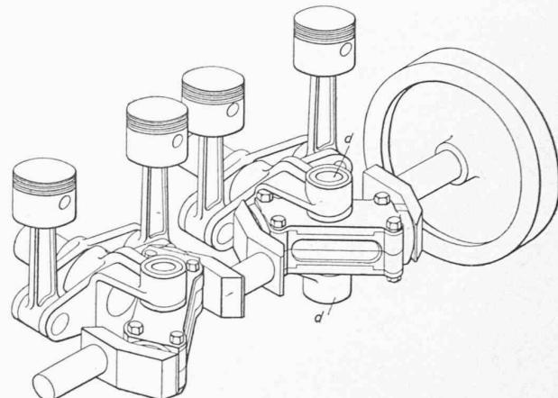
Abb. 3. Perspektivisches Bild der „Synchro-Balance-Engine“.
