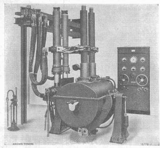
Elektrischer Metallschmelzofen für Dreiphasenstrom, mit hydraulischer Hand- und automatischer Elektrodenregulierung. Fassungsvermögen 600 kg.
