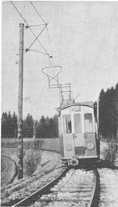
Abb. 2. Fahrleitung der Uetlibergbahn.
