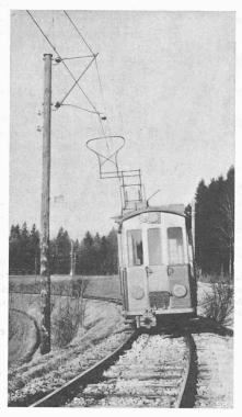
Abb. 2. Fahrleitung der Uetlibergbahn.
