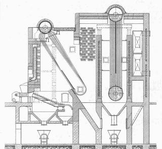
Sulzer-Höchstdruck-Kesselanlage (Patente angemeldet)
