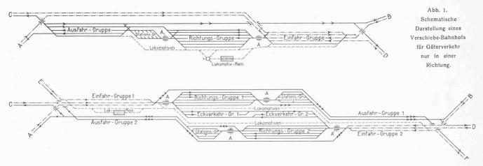
Abb. 2. Schematische Darstellung eines Verschiebe-Bahnhofs für Güterverkehr in beiden Richtungen (zweiseitiger Verschiebebahnhof).
