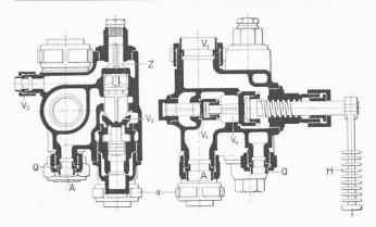
Abb. 2 und 3. Vertikalschnitt durch das Anlass- und Umschaltventil.
