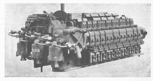
Abb. 14. Wendeschalter mit elektro-pneumatischem Antrieb der Lokomotive Nr. 10401.
