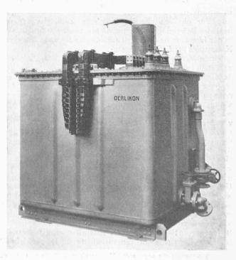
Abb. 11. Transformator der Lokomotiven Nr. 10401 bis 10420.
