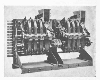
Abb. 13. Stufenschalter für elektrische oder Handsteuerung.
