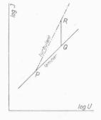
Uebergang von der laminaren zur turbulenten Bewegungsweise (Abb. 1) rückt gegen den Punkt P umso näher heran, je grösser die Störung ist. Dem Punkte P, dem etwa  $E_p = 1160$  bei gezogenen Messing-Rohren nach den Versuchen von Schiller entspricht, kommt nun besondere Bedeutung zu; von P ab kann nämlich überhaupt erst die laminare Bewegung in die turbulente übergehen. In P
