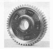
Abb. 8. Gefederter Zahnkolben der Triebmotoren.
