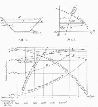
Abb. 2. Wassermengen und Höhen der Staukurven am Ueberfall, sowie Wasserspiegelflächen im Staubecken bei verschiedenen Wasserspiegelhöhen.
