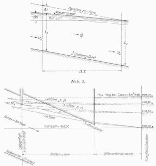
Abb. 1. Längenprofil zwischen Ueberfall und Ausgleichbecken, mit Staukurven für verschiedene Wasserspiegel-Lagen, 200-fach überhöht.
